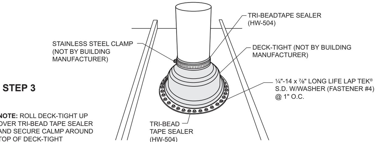
**NOTE:** ROLL DECK-TIGHT UP OVER TRI-BEAD TAPE SEALER AND SECURE CALMP AROUND TOP OF DECK-TIGHT
