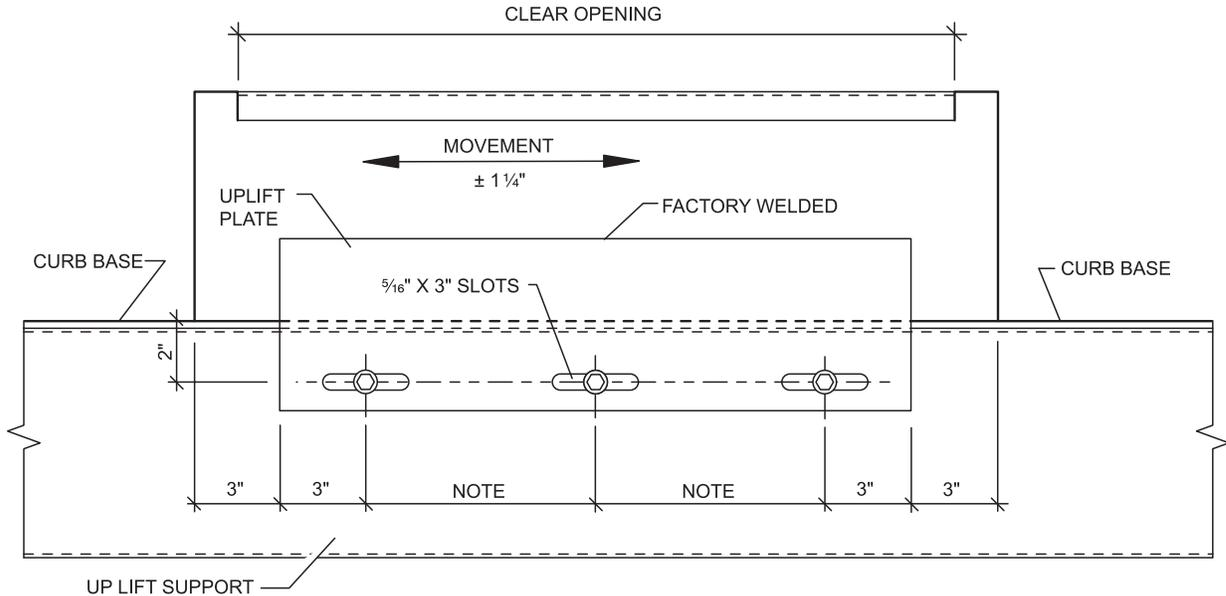
**NOTE:** SLOT LOCATION IS DETERMINED BY THE CURB LENGTH, MAXIMUM SPACING IS 12" O.C.
